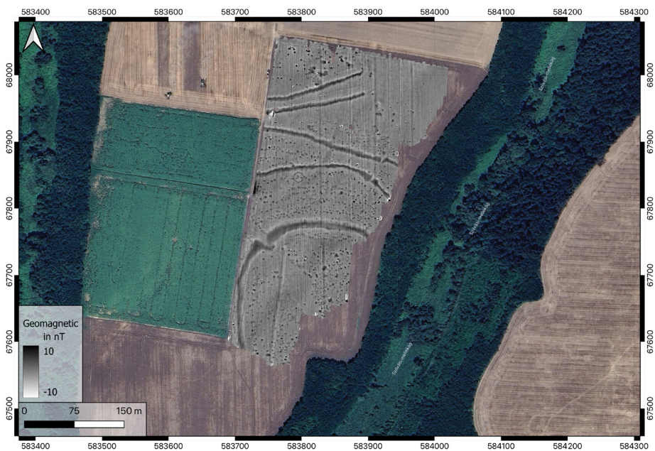
3. Kép. A geomágneses felmérés eredményeként látható árkok a Bing Maps műholdképre vetítve (EPSG:3857) (© KieLi Egyetem, a térképet Furholt Kata készítette).
